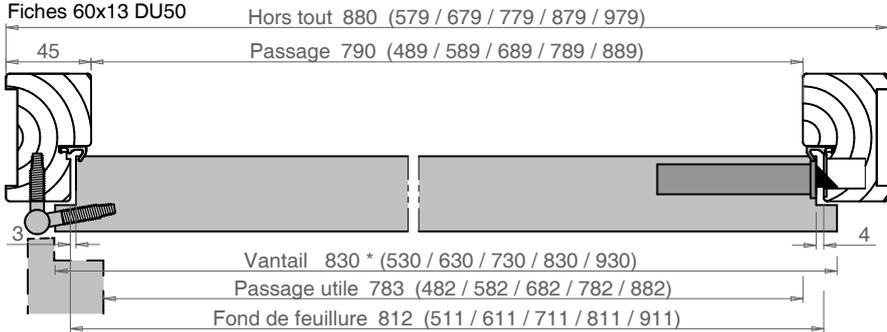
Version crémonne à rouleaux : recouvrement du vantail de 18mm (côté serrure) et Hors-tout huisserie -7mm
