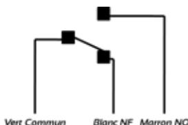
Figure 8 - Contact appuyé : Porte fermée
