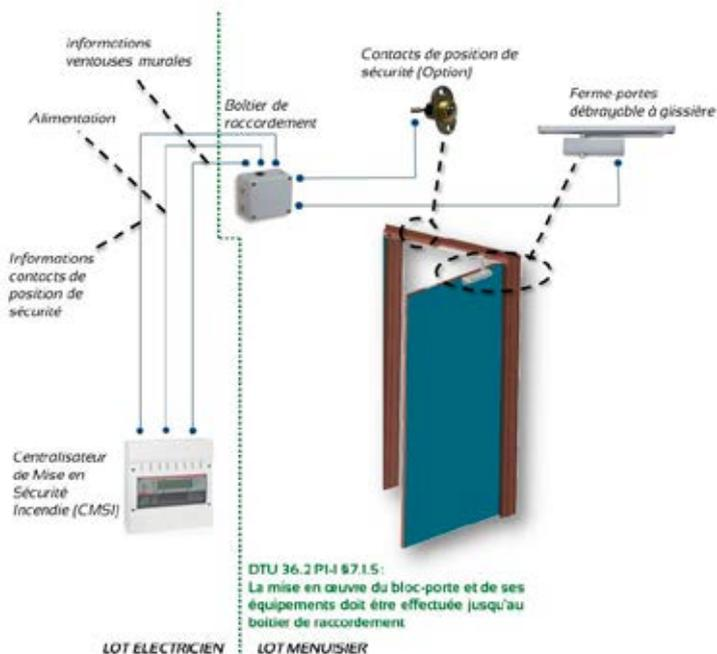
Figure 1 - Schéma de principe du bloc-porte DAS
