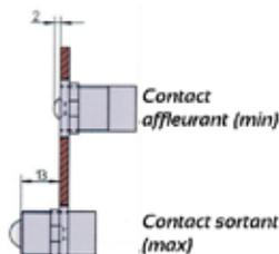
Figure 10 - Course du contact de position de sécurité
